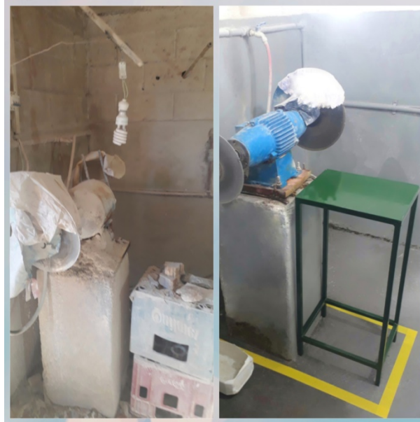
Imagen 32. Antes y después amoladora de banco.
