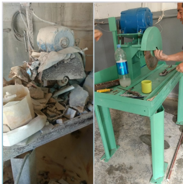
Imagen 14. Antes y después de recuperación de disco de corte secundario.
