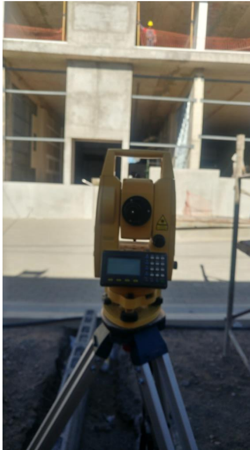
Figura 4.1.2: Imagen de Estación Total
