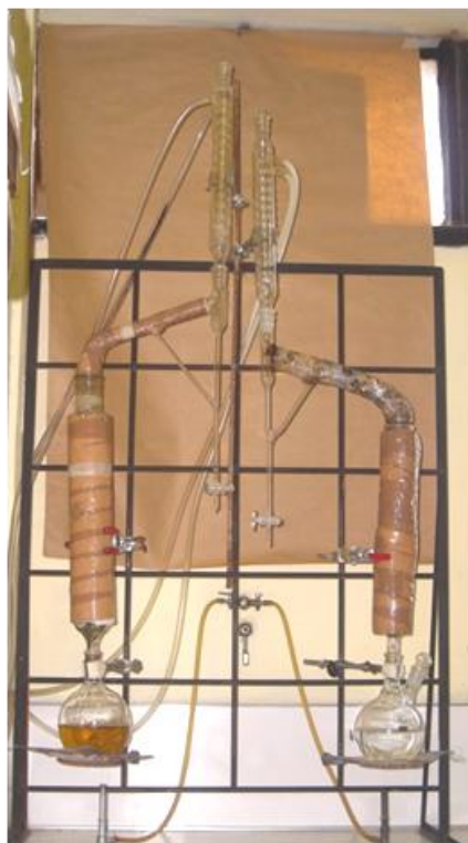
Figura III.2: Destiladores tipo Clevenger utilizados para la extracción del AE de T. minuta .
