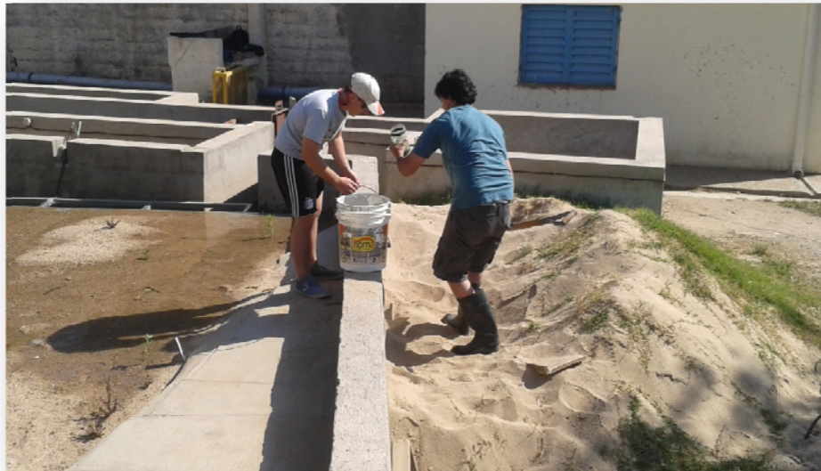
Figura 66: Medición volumen arena arrojado en cada río.
