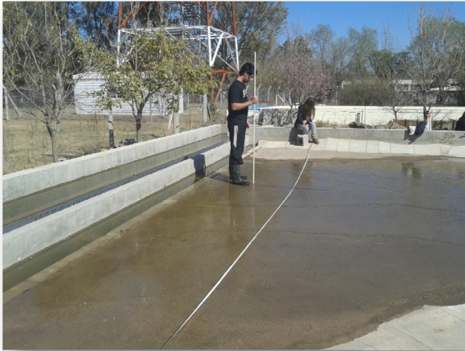
Figura 35: Medición de la superficie del cauce y del agua mediante nivel y mira.
