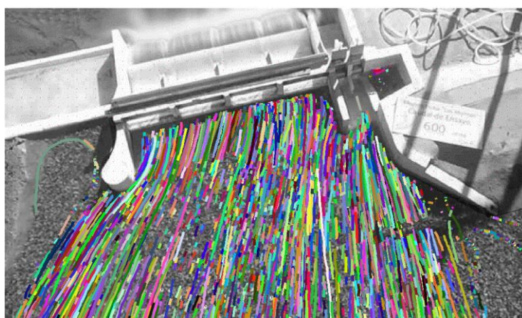
Figura 36: Líneas de flujo. Ensayo 1
