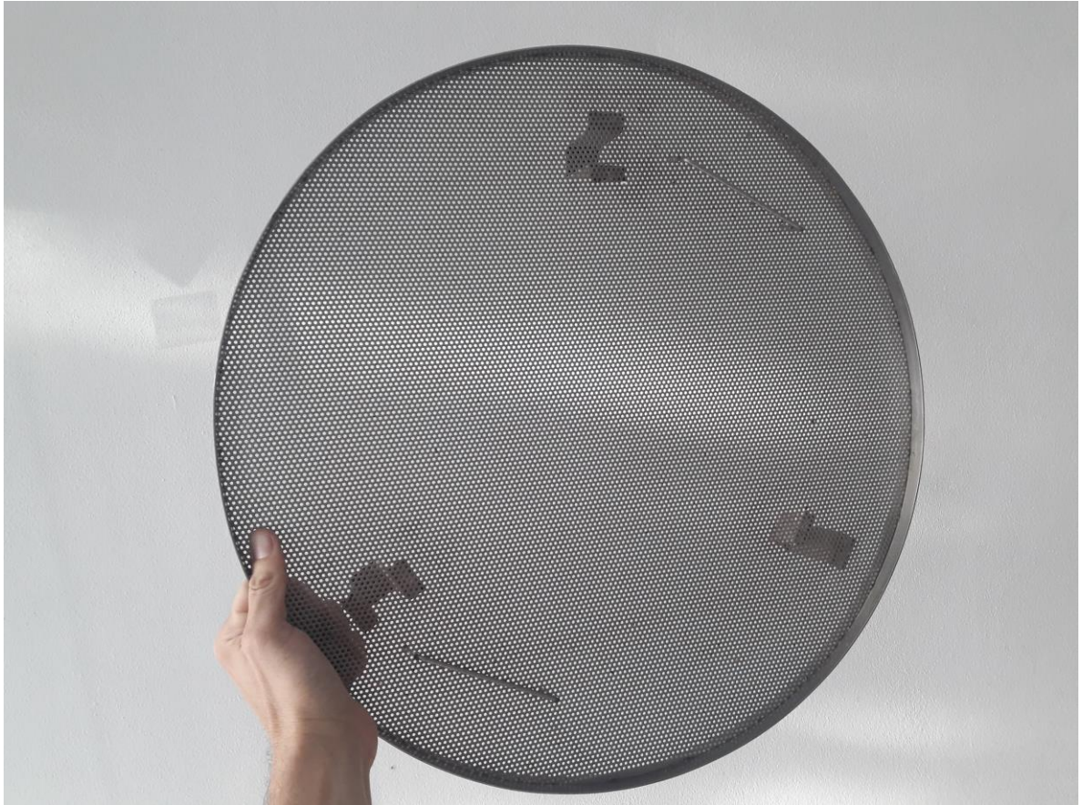
Figura 12: Falso fondo de macerador.
