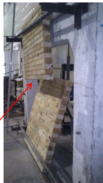
ROTURA DEL PANEL
