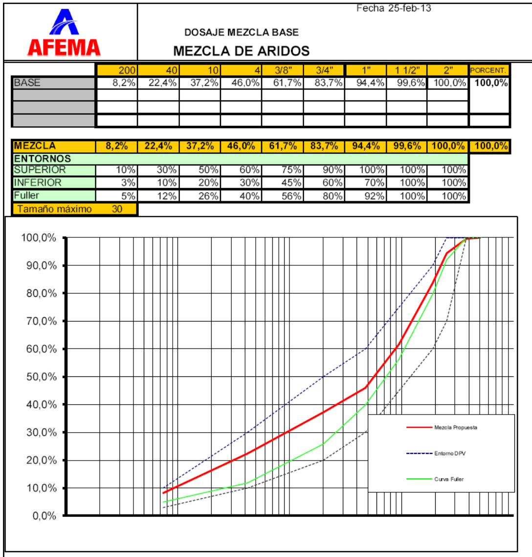
Figura 43: Dosificación Base Granular [CBR]
