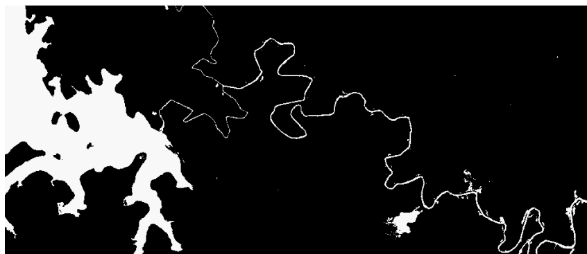
Figura 5.21: Resultado de la clasificación supervisada ML de las 6 bandas de la imagen Landsat 5 TM (fecha: 26 – 07 – 2010) empleada. Se utilizó como regiones de entrenamiento a muestras determinadas de manera visual en la imagen óptica. Esta clasificación de la imagen Landsat fue empleada como verdad de campo a la hora de evaluar los clasificadores de imágenes COSMO-SkyMed desarrollados.
