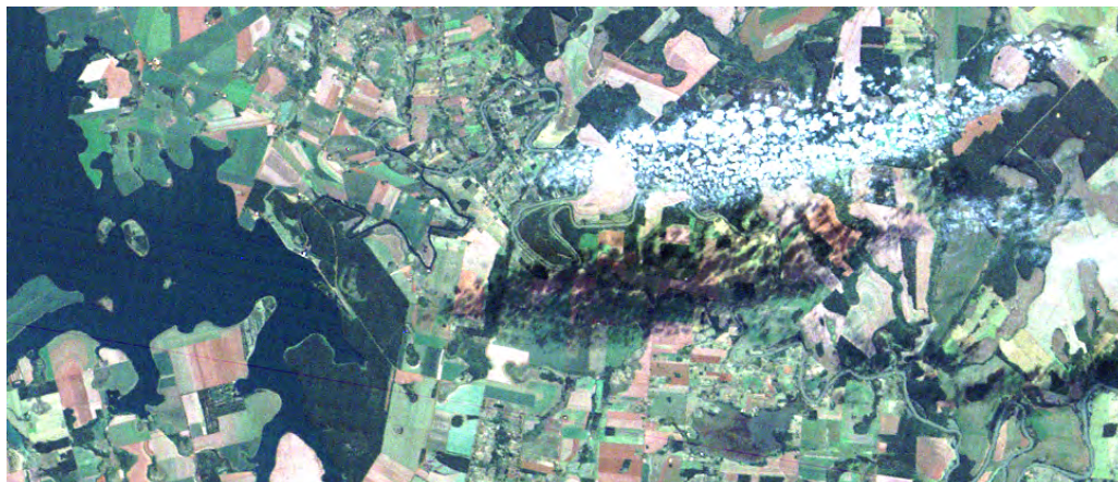
(a) Imagen Landsat 5 TM: combinación de bandas 3,2,1 (Rojo, Verde, Azul). Path: 224, Row: 78. Los valores de la imagen corresponden a valores de reflectancia.
