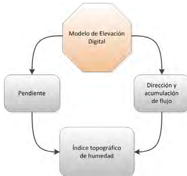
Figura 2.6: Productos del modelado hidrológico que fueron generados en el presente capítulo a partir de un modelo de elevación digital (DEM): 1) pendiente, 2) dirección y 3) acumulación de flujo, e 4) índice topográfico de humedad (TWI). A partir del DEM se obtienen la matriz de pendiente, de dirección y acumulación de flujo. El TWI combina estos últimos productos.
