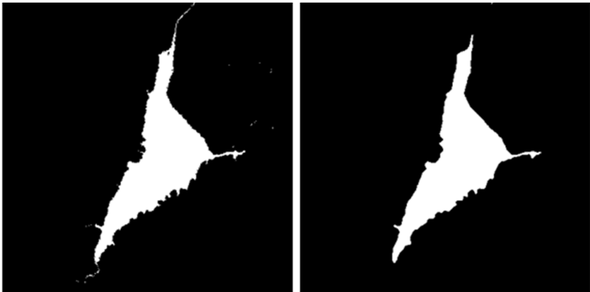
Figura 6.18: Izquierda: Clasificación de píxeles de agua de la imagen de la Figura 6.17 mediante el uso de un umbral igual a 0,017 correspondiente a la banda TM7. Derecha: Efecto de la aplicación de un filtro de mediana de 5x5 sobre la imagen de la izquierda.
