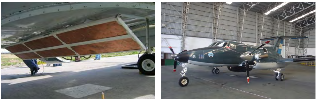
Figura 3.1: Sensor Aerotransportado SARAT (Izq: el sensor en detalle; Der: avión Beechcraft Super King Air B-200, que transporta el sensor) .
