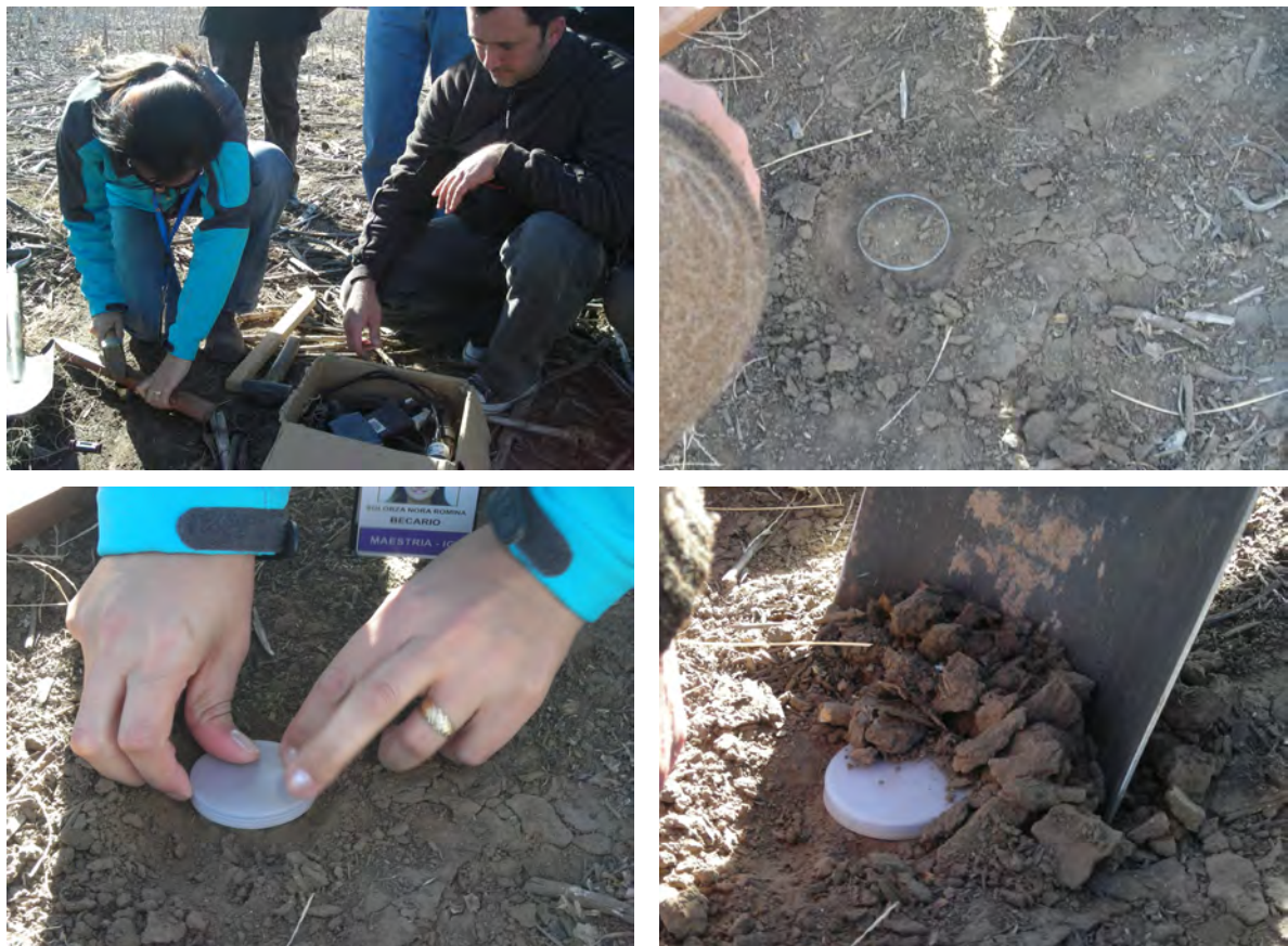
Figura 3.12: Extracción de muestras de suelo en campo con el método gravimétrico .
