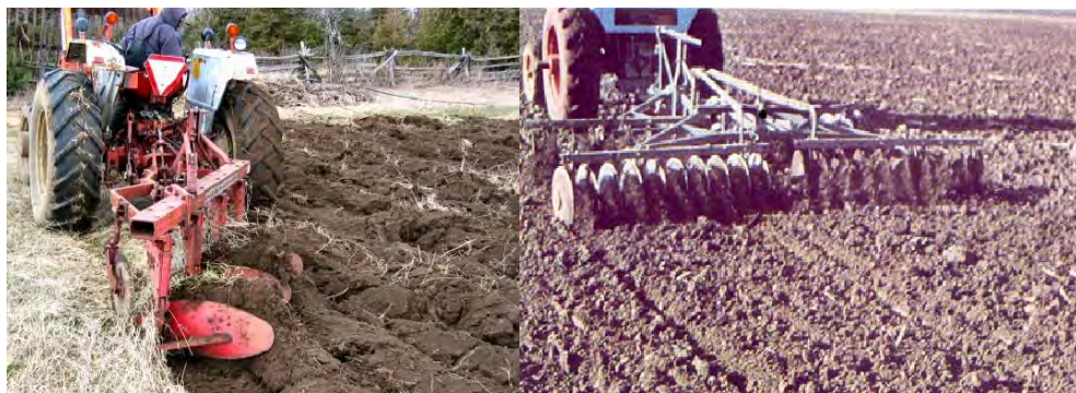
Figura 3.14: Izquierda: Arado de reja y vertedera (moldboard plow). Derecha: Arado de disco doble acción (double-acting disk) (Barber et al., 2011) .
