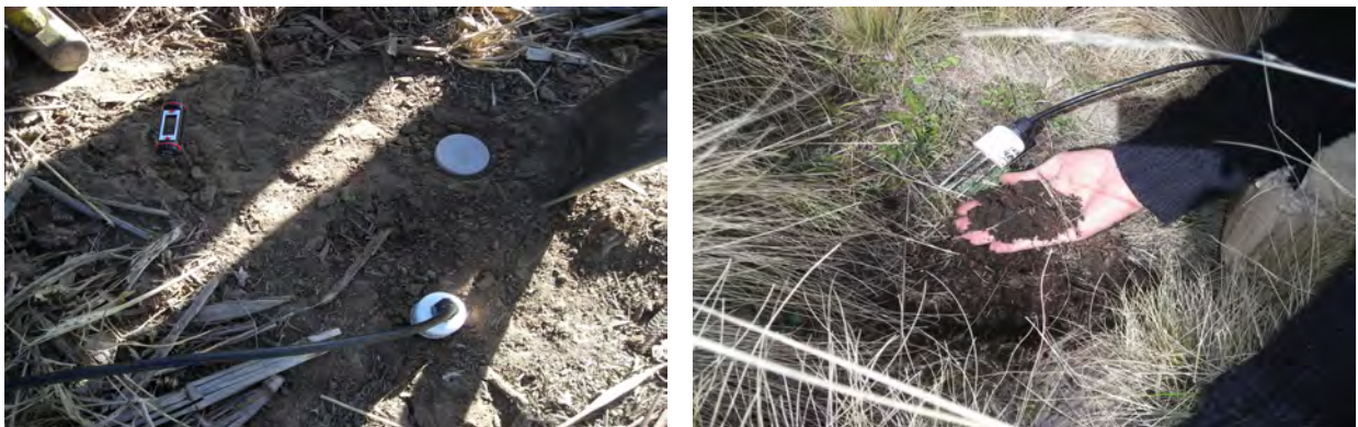
Figura 3.11: Medición de humedad del suelo con la sonda HP II Stiven .
