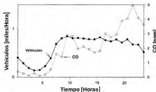
FIGURA 2.3: Frecuencia de vehículos por hora que circulan durante un día en la calle Junín, junto con registros de concentración de CO, para el año 1999 (adaptado de Bogo et al., 2003).
