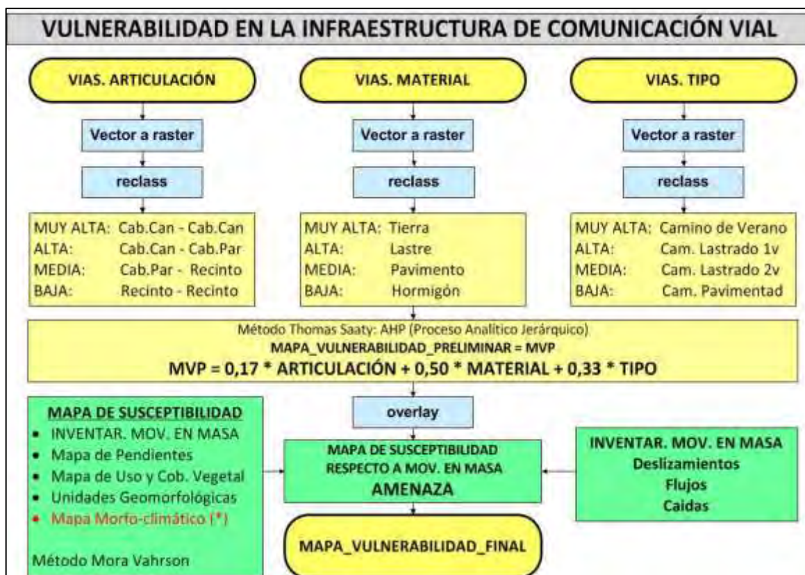
Diagrama V.012 Estructuración de la Vulnerabilidad en la Infraestructura de Comunicación Vial
