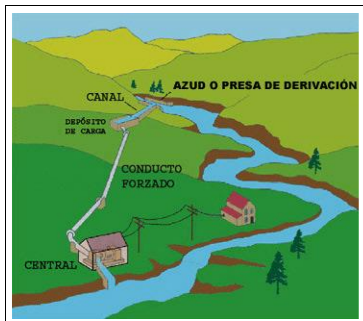
Figura 46. Esquema de Central Hidroeléctrica de Aguas Fluyente.
