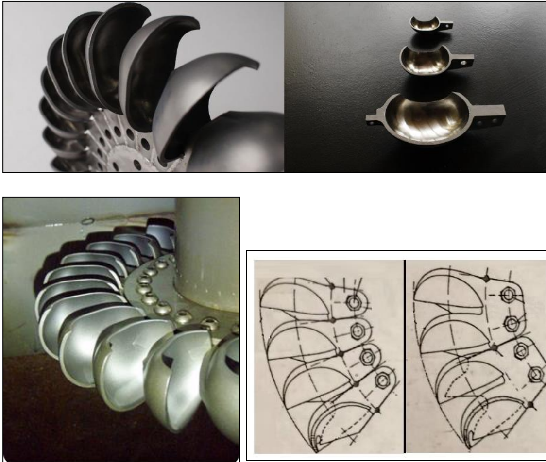
Figura 71. Diferentes tipos de alabes de con material de Fundición. (www.wikipedia.com)
