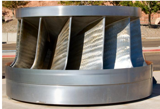
Figura 54. Rodete de una Turbina Francis. (www.wikipedia.com)
