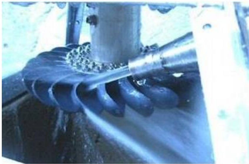
Figura 58. Imagen de una Turbina Turgo en Banco de prueba. Universidad Pública de Lima.
