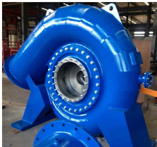
Figura 53. Cámara espiral de entrada de una Turbina Francis. (www.wikipedia.com)
