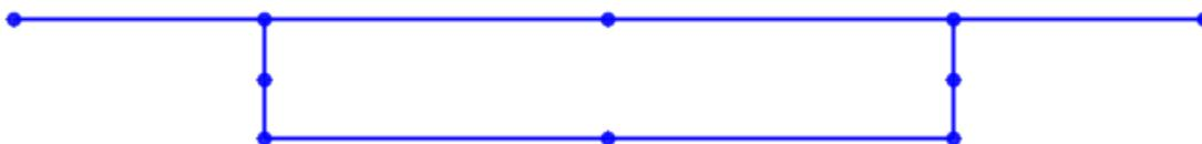
Figura 34: Corte transversal del modelo de viga sección cajón.
