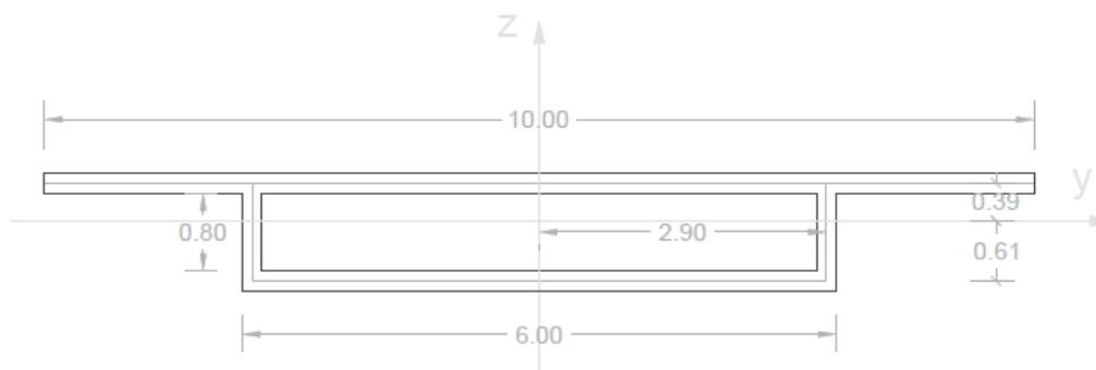
**Figura 46: Corte transversal de viga sección cajón propuesta del caso 1. Fuente: Elaboración propia.**
