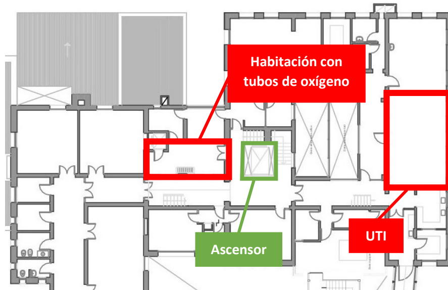
Imagen 3.7.- Tubos de oxígeno cerca de UTI
