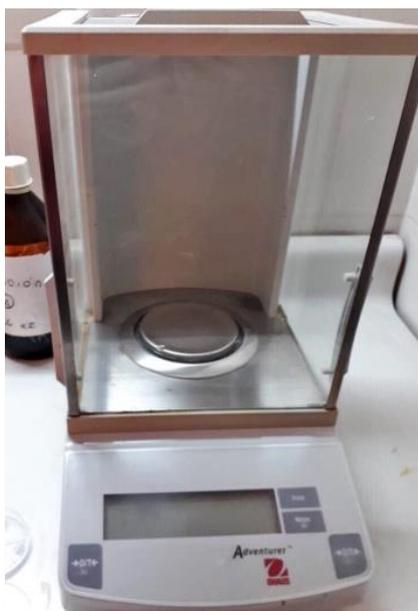
Ilustración 18 - Balanza de precisión.
