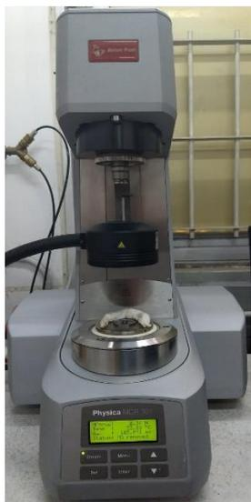
Ilustración 23- Reómetro Rheoplus Physica MCR 301 (Anton Paar).
