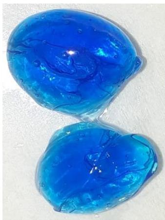
Ilustración 21 - Esferas de hidrogel de alginato con azul de metileno.
