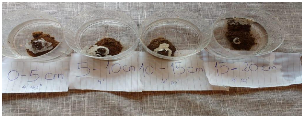
Imagen 11: Ensayo de estabilidad estructural
