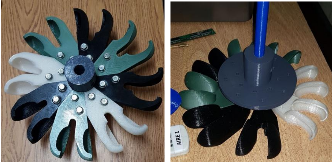
Figura 77. Rodete impreso en plotter 3D
