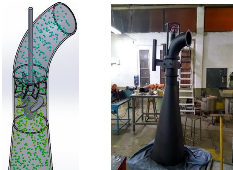
Figura 10. Simulación y turbina construida. Turbina axial.
