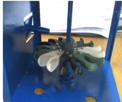
Figura 15. Banco de pruebas micro turbina Turgo.
