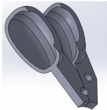
Figura 33. Diseño álabe turbina Turgo.
