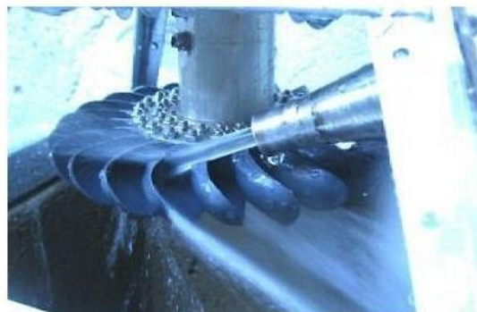
Figura 16. Turbina Turgo. (Fuente: Mohaded, 2018. Turbina hidráulica para generación de energía).
