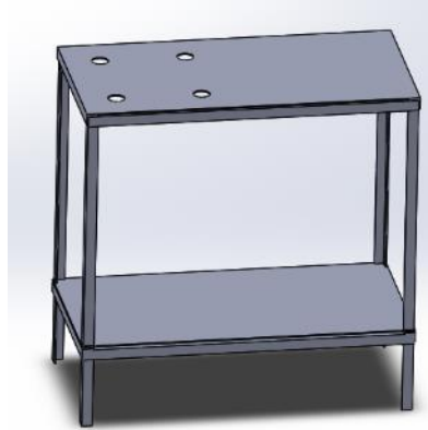
Figura 70. Mesa de apoyo del sistema turbina-bomba-alternador
