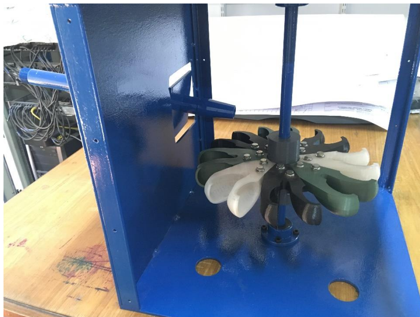
Figura 78. Caja del banco de prueba con turbomáquina terminada
