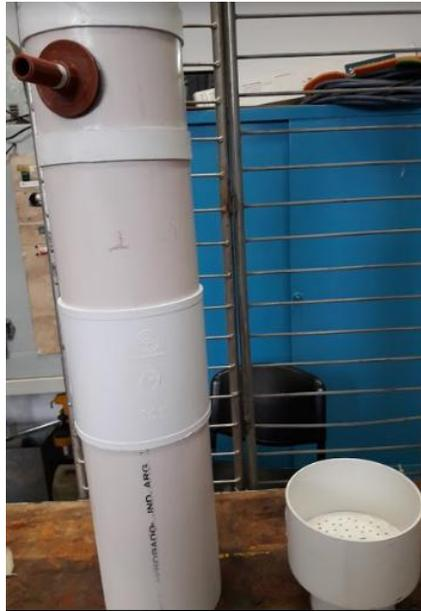
**Figura 17.** A la izquierda, la cañería modificada y a la derecha la cupla de reducción con la doble tapa perforada.
