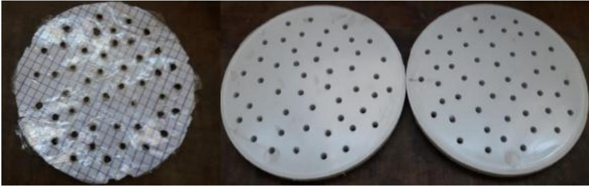
**Figura 22.** A la izquierda la grilla con las perforaciones, y a la derecha las doble tapa perforadas.
