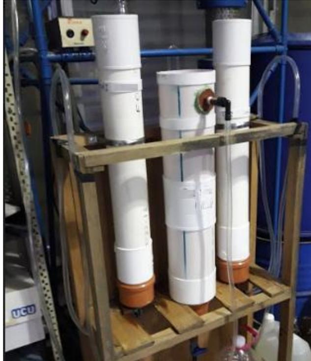
**Figura 24.** Equipos de filtración (en los extremos) y prefiltro (en medio).
