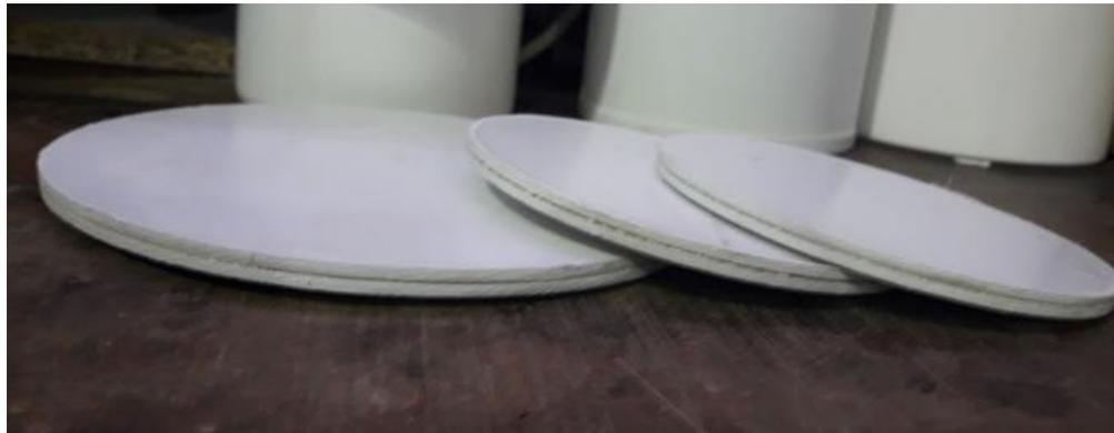
**Figura 21.** De izquierda a derecha, la doble tapa del prefiltro y las dos de los filtros
