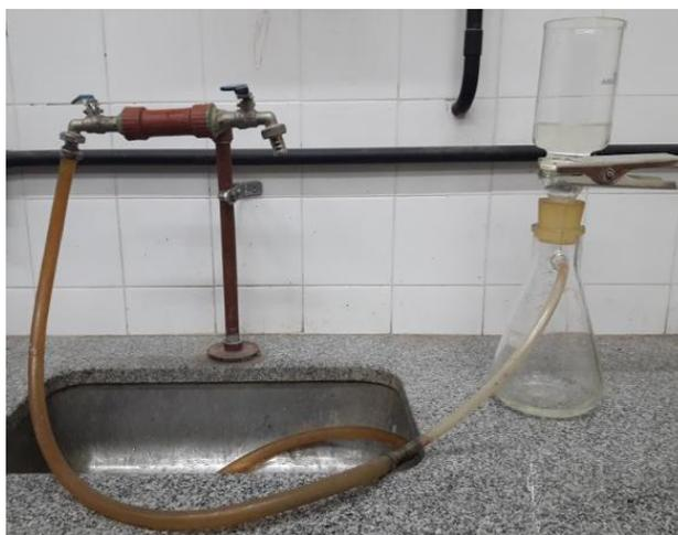
**Figura 31.** Dispositivo para crear vacío, kitasato con tapón y vaso contenedor de muestra, sostenido por una pinza metálica.
