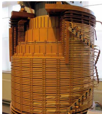
Fig. 4 BOBINADO DE UN TRANSFORMADOR
