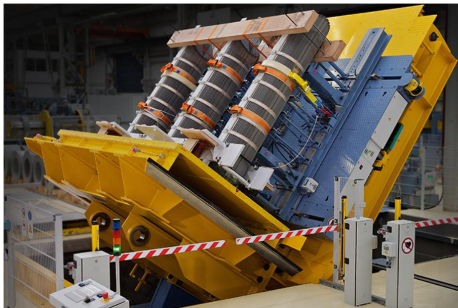
Fig. 15 MESA IMPULSADA POR SISTEMA HIDRÁULICO SOBRE FUNDACIÓN
