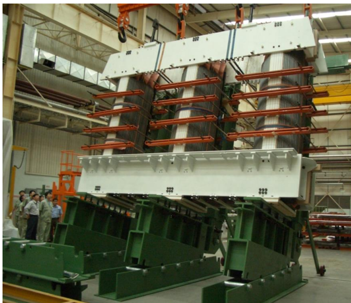
Fig. 14 MESA IMPULSADA POR PUENTE GRÚA
