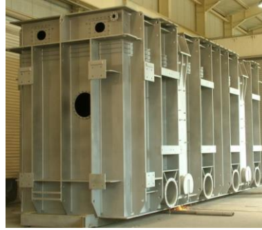
Fig. 5 CUBA DE UN TRANSFORMADOR
