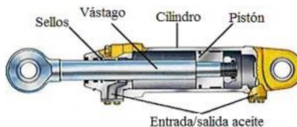
Fig. 79 PARTES DE UN ACTUADOR HIDRÁULICO
