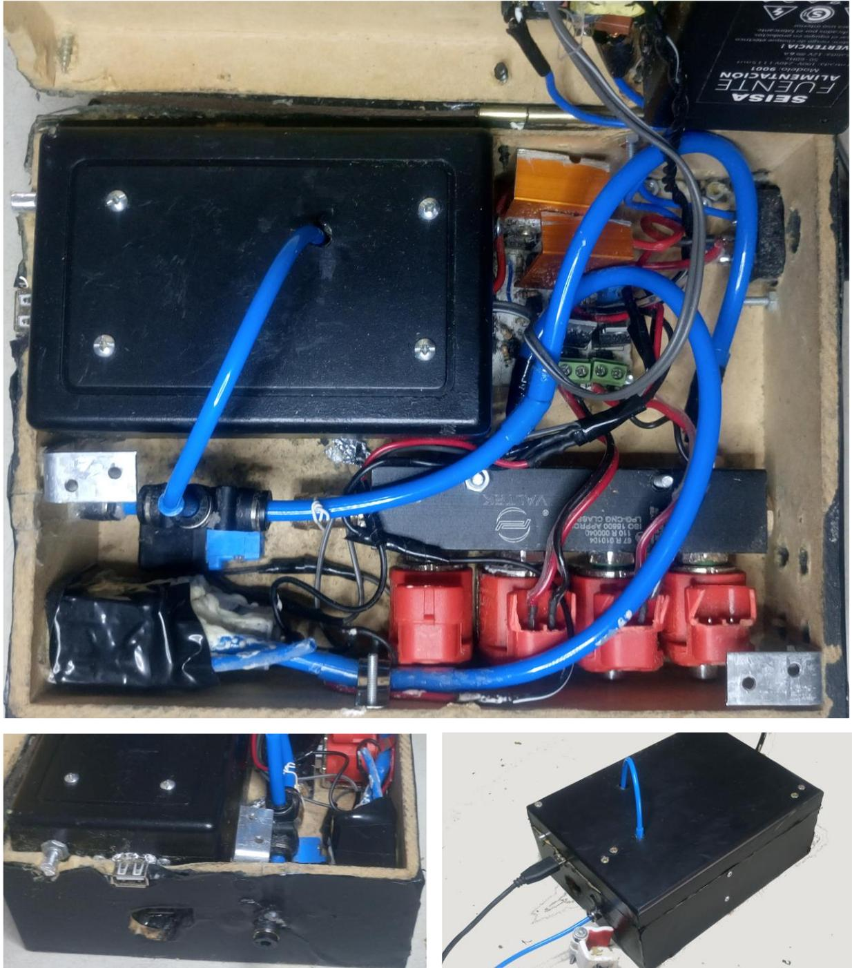
Ilustración 57: Fotografías del Prototipo finalizado. Arriba: Vista superior del interior del gabinete. Abajo Izquierda: Panel frontal de conectores. Abajo Derecha: Gabinete cerrado con dispositivo de medición conectado.
