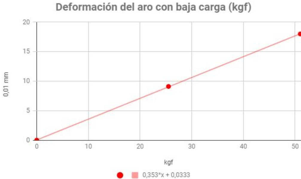
**Ilustración 33: Recta de máximo ajuste de deformación del aro con baja carga**
