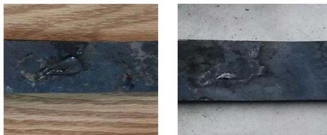
Ilustración 21: Carboximetilcelulosa antes y después de colocarla a 600 °C y 1000 °C
