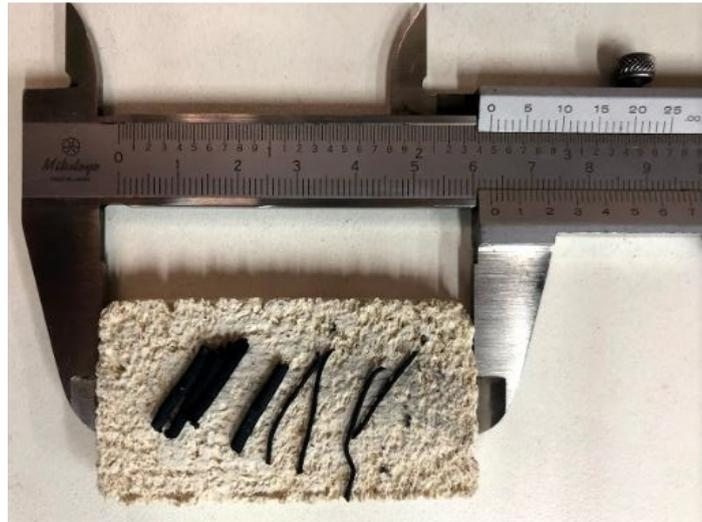
**Ilustración 48: Muestras de hidruro de titanio y carboximetilcelulosa sinterizadas en atmósfera de vacío**
