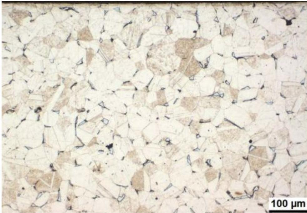
Ilustración 15. Ultrafuse 316LX, sinterizado en hidrógeno a 1360 °C<sup>15</sup>
