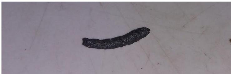
Ilustración 17: Filamento de polvo de aluminio y silicona en barra
