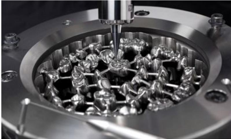
Ilustración 6: Coronas de Cromo-Cobalto fabricadas por mecanizado con Datron D5<sup>6</sup>
