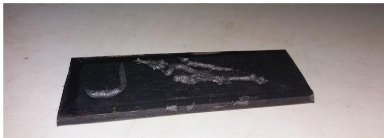
**Ilustración 19: Mezcla de polvo de magnesio y silicona líquida**
