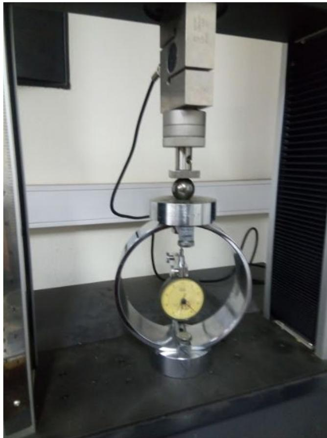
Ilustración 27: Verificación de la calibración con aro dinamométrico.
