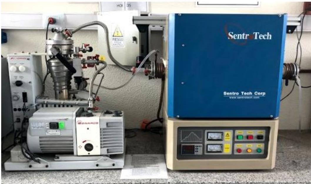
Ilustración 32: Sistema de sinterizado con bomba de vacío
