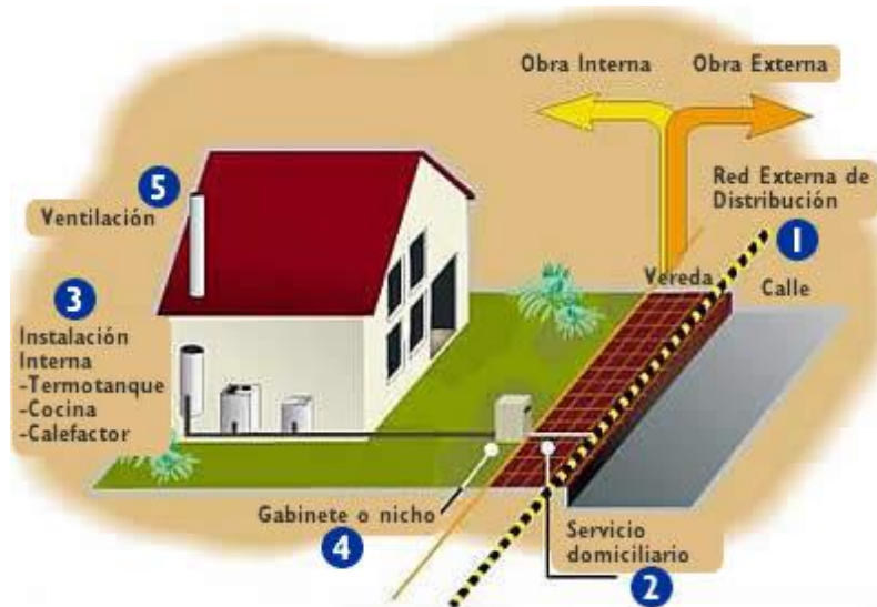
Figura 3.6.5. Distribución de gas por redes.
