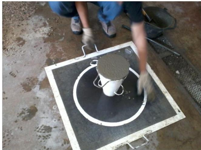
Fig. Nº 5.2 Ensayo de extendido
