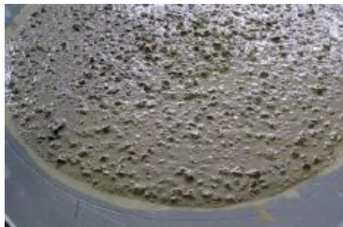
Fig. N° 5.8 Extendido segregado
