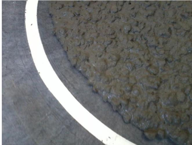
Fig. N° 5.4 control visual de estabilidad de la mezcla
