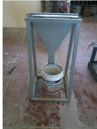
Fig Nº 5.9 Embudo en V (medidas en mm)
