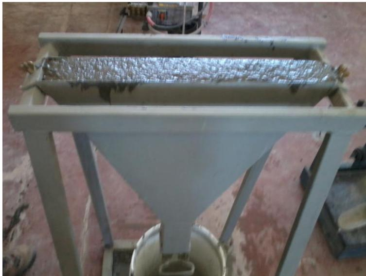
Fig. Nº 5.10 Ensayo de embudo en V
