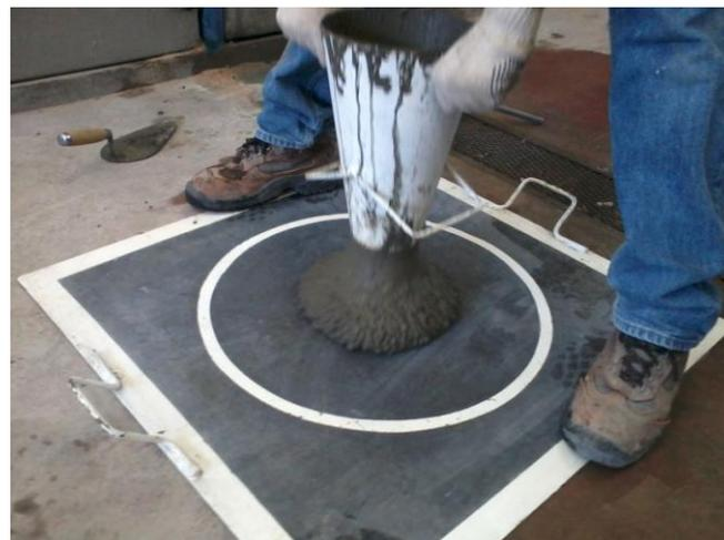
Fig. Nº 5.3 Ensayo de extendido
