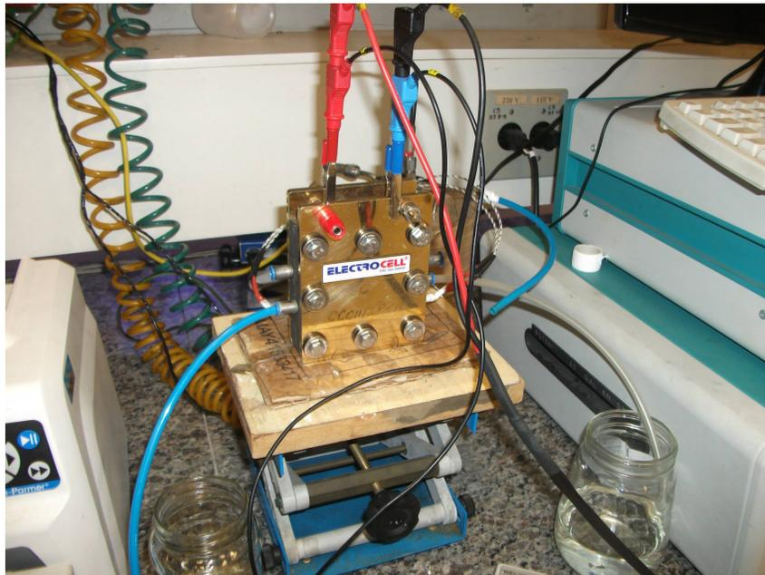
Figura 1.2: Fotografía de una PEMFC fabricada por la empresa Electrocell.
