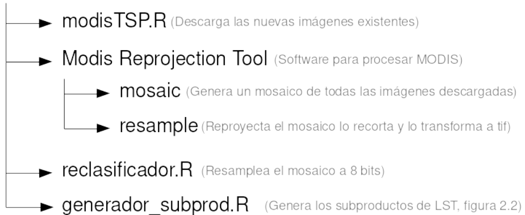
Figura A.1: Descripción de rutina y sub rutinas de descarga y pre procesamiento para los productos de temperatura de suelos
