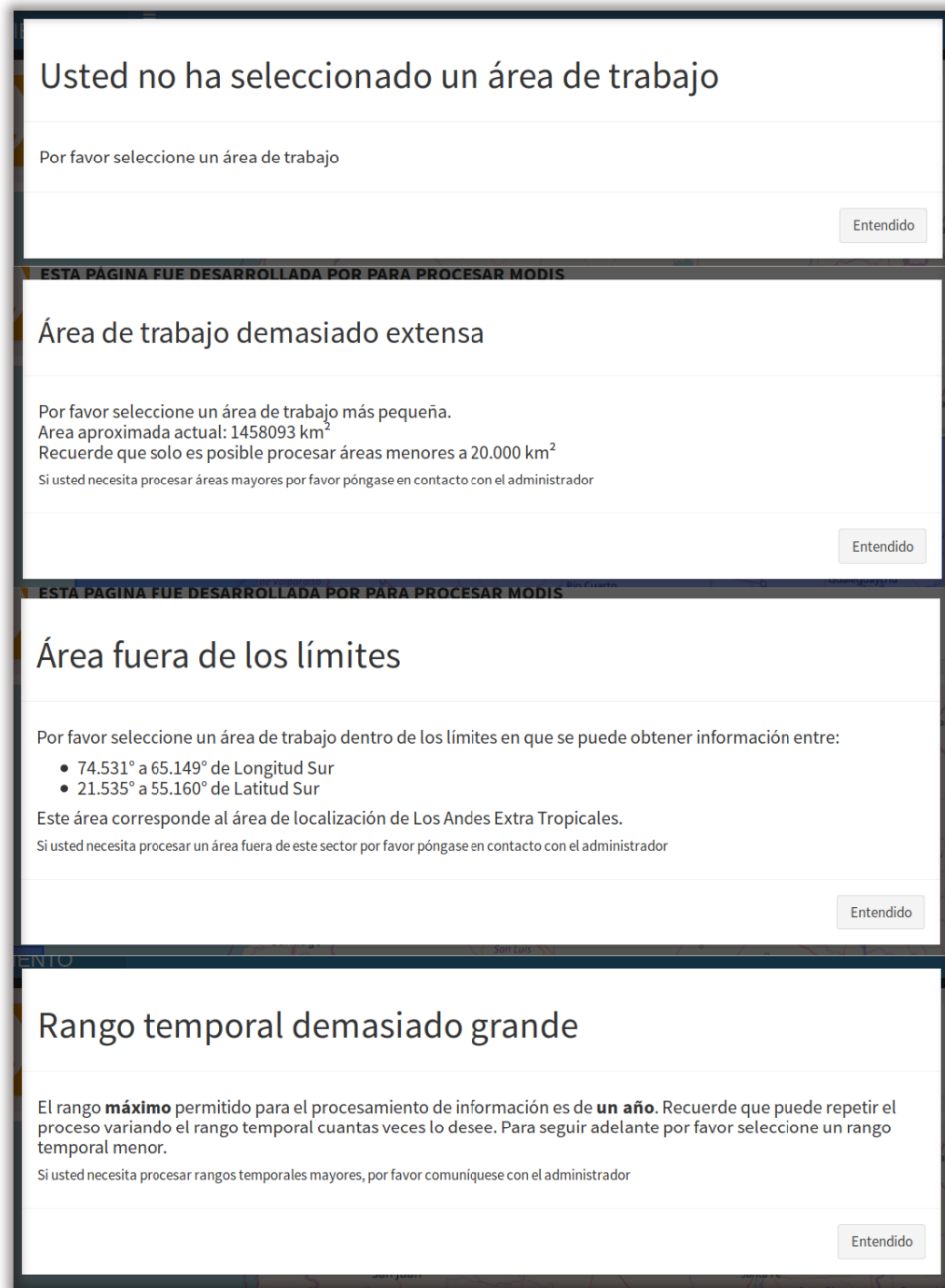
Figura 4.6: Ventanas modales de control que se despliegan cuando la selección de filtros en la barra de herramientas ha sido realizado en forma errónea o excediendo los límites impuestos en la plataforma, tales como superficie no mayor a 20.000 km 2 o un período mayor a un año. Su función es alertar al usuario, evitar procesamientos muy largos, y evitar bugs en el sistema.
