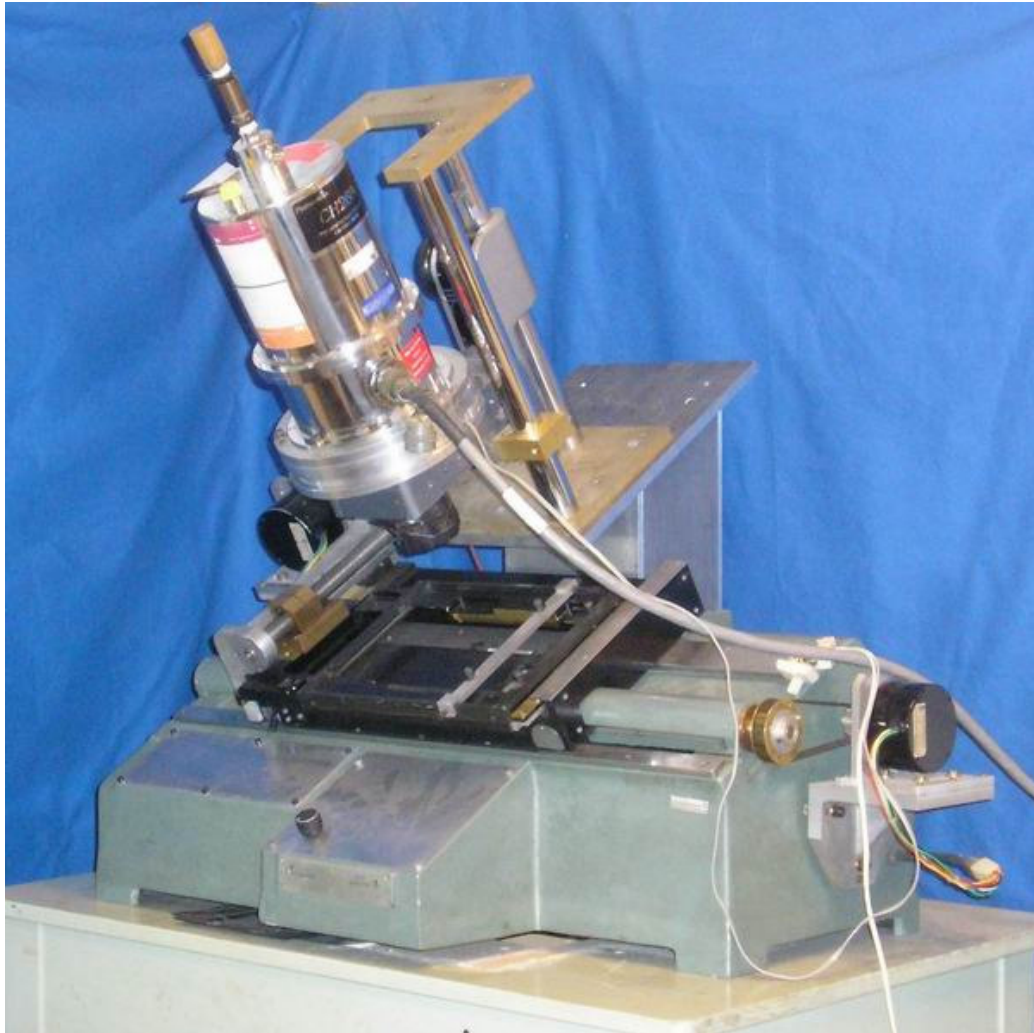
Figura 59. Microdensitómetro Hilger-Watts adaptado para el desplazamiento bidimensional de la placa mediante motores paso-a-paso y la digitalización con la cámara CCD CH-260 montada en la torre.
