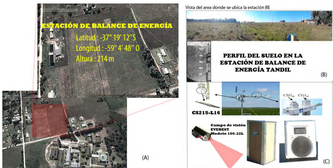
FIGURA 20: (A) Ubicación de la estación de Balance de Energía en Tandil, Argentina. (B) Vista del área donde se ubica la estación y perfil de suelo. (C). Muestra de sensores CM3 CG3 utilizados para medir radiación solar, y de instrumentos portátiles disponibles (radiómetro EVEREST, caja de emisividad y cuerpo negro de referencia).
