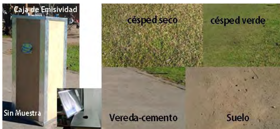
FIGURA 18: Caja de emisividad y tipo de superficies observadas.
