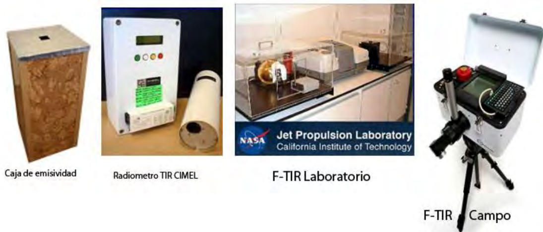
FIGURA 8: Caja de emisividad usada para obtener la ESS (construida en el marco de esta tesis) (izquierda), el radiómetro CIMEL usado para obtener diferentes anchos de bandas para estimar la ESS (centro CIMEL y Laboratorio de medidas de emisividad) y el instrumento F-TIR usado para obtener un espectro de emisividad en un rango de 8 a 14 \mu\text{m} (derecha). Extraído de http://ceh-flumen64.cedex.es/Ecosistemas/Observaci%C3%B3nTierra/sobrino.pdf
