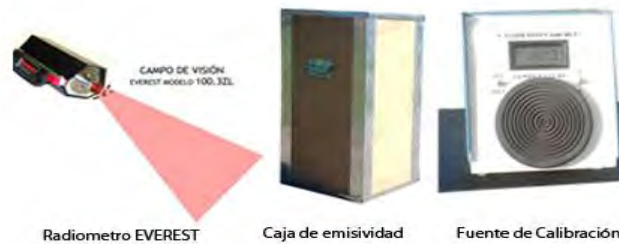
FIGURA 16: Instrumentos necesarios para la estimar la emisividad de una muestra.
