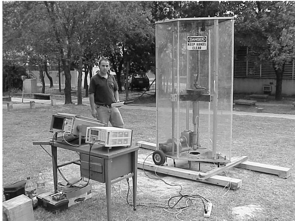
Fig. 9.5: Ensayo impulsivo sobre el bloque de fundación
