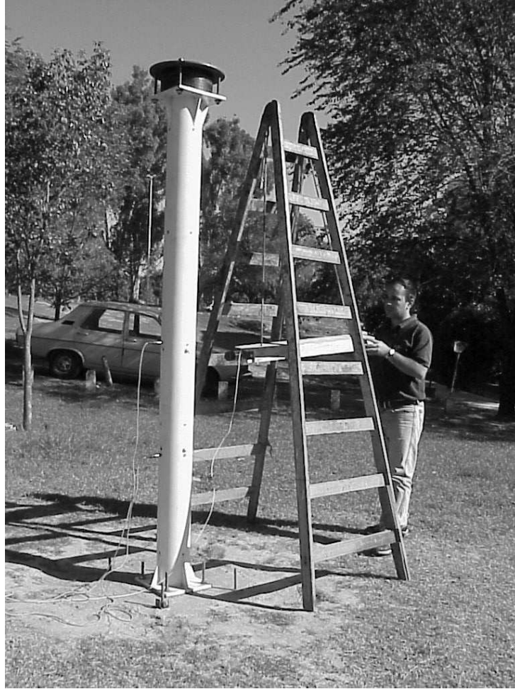
Fig. 9.30: Ejecución del ensayo de impacto del sistema acoplado
