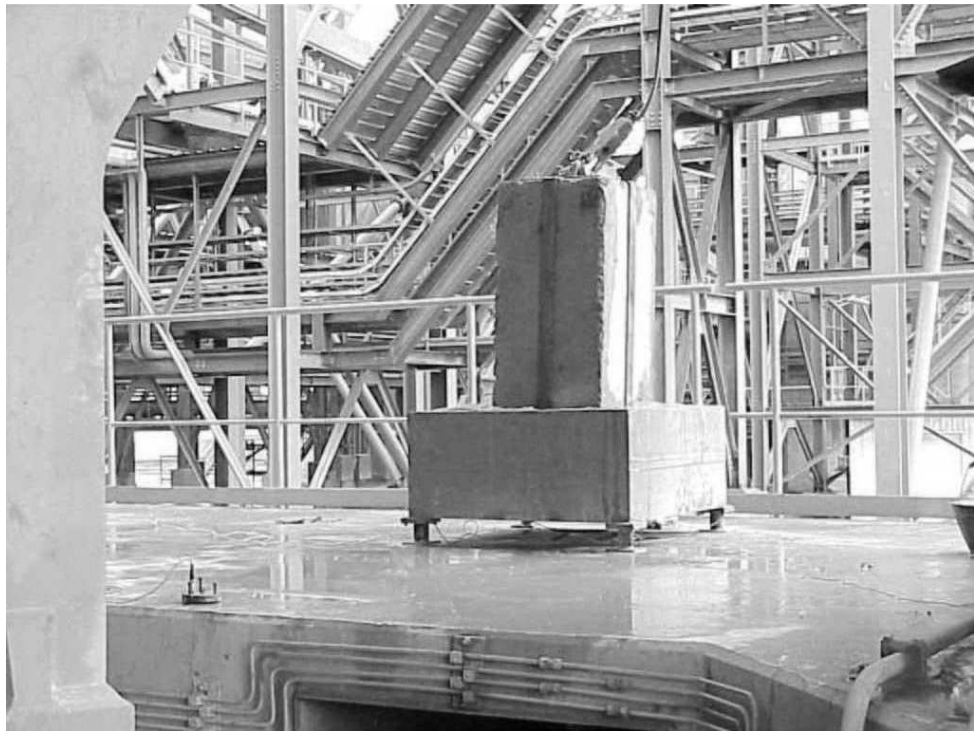
Fig. 9.49: Martillo sobre la plataforma luego del impacto
