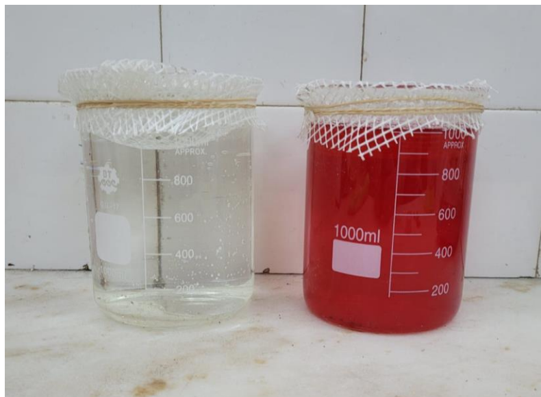
Figura 2.3: “Jar slake test”: vasos de precipitado con agua y querosén.
