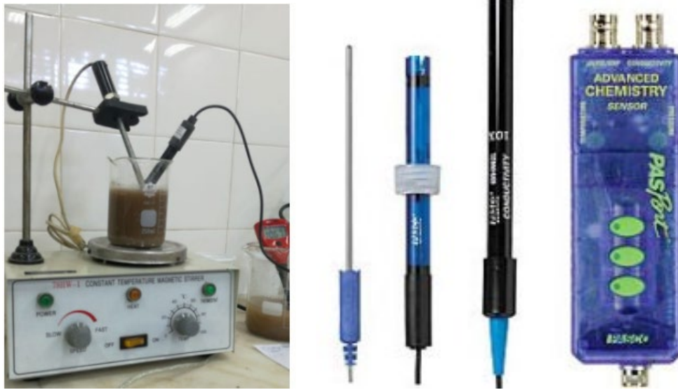
Figura 3-14 Ensayo de conductividad eléctrica propuesto por Luxan et al., (1988), junto con los sensores utilizados.
