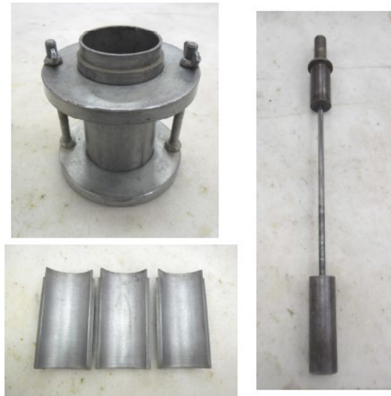
Figura 3-21 Molde tripartido de acero inoxidable y pisón de compactación.
