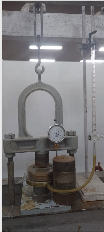
Figura 3-24 Celda de consolidación combinada con permeámetro, laboratorio de Geotecnia FCEFN.
