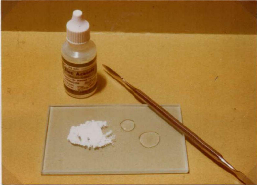
Figura 25: Acetato de cinc en estado líquido que se utiliza para disminuir el tiempo de endurecimiento de la mezcla.
