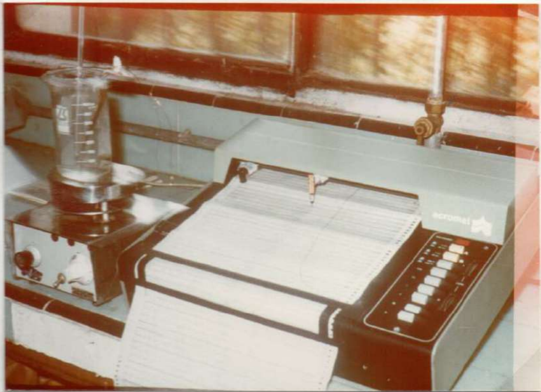
Figura 93. Fuente de calor, termostato y registrador realizando la medición de una muestra.
