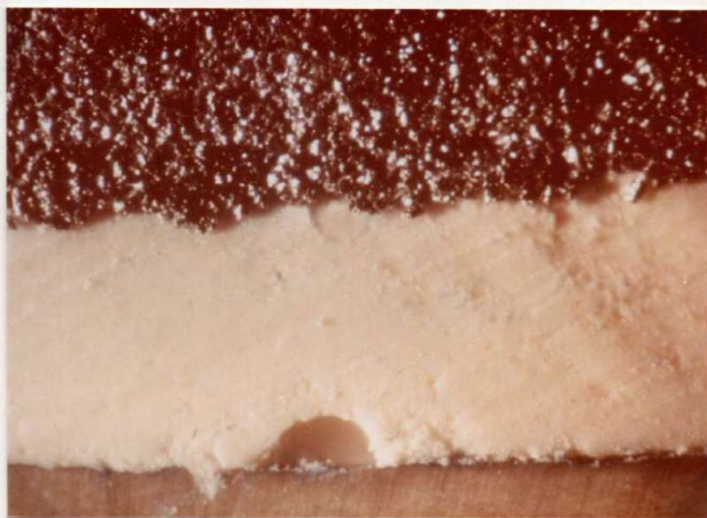
Figura 62. La zona de la figura anterior luego de las presiones de condensación. El poro de / aire atrapado no ha sufrido modificación.
