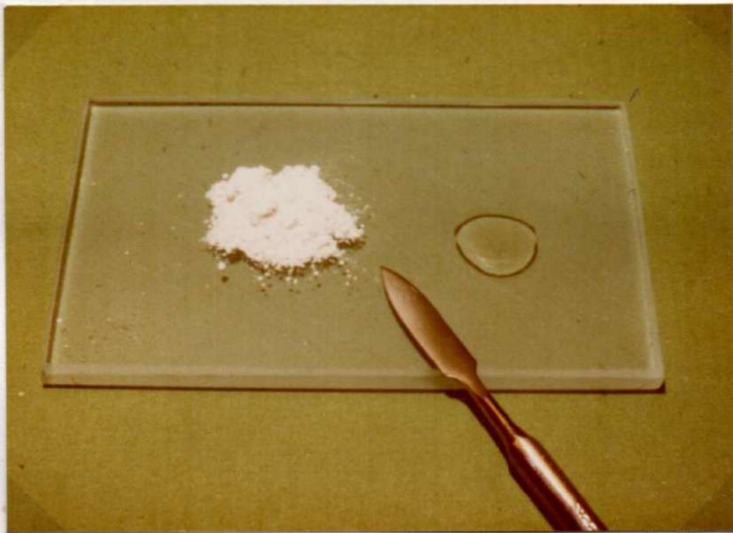
Figura 23. Instrumental adecuado, conteniendo las proporciones convenientes de polvo y líquido para efectuar la mezcla.
