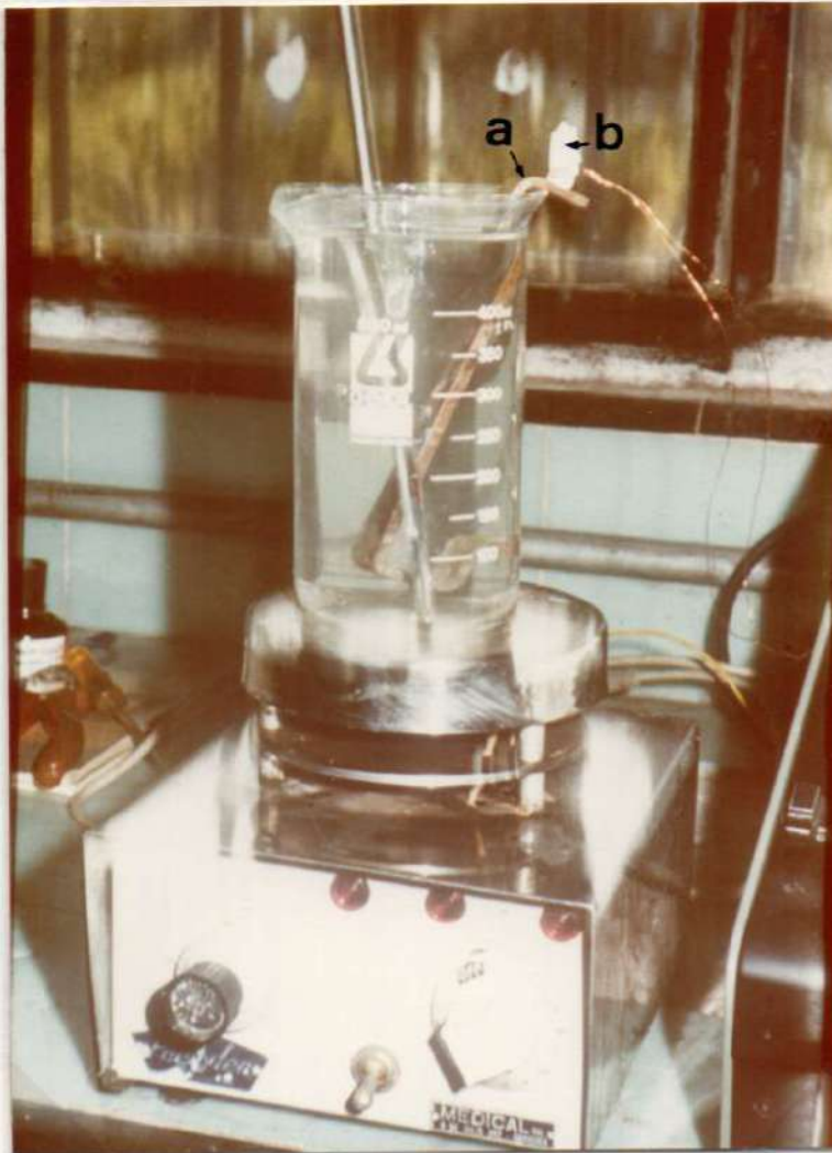
Figura 91. Termostato que mantiene el agua con una temperatura constante de 58^{\circ}\text{C} . Se observa: a-barra de cobre y b-elemento dentario con las termocuplas.
