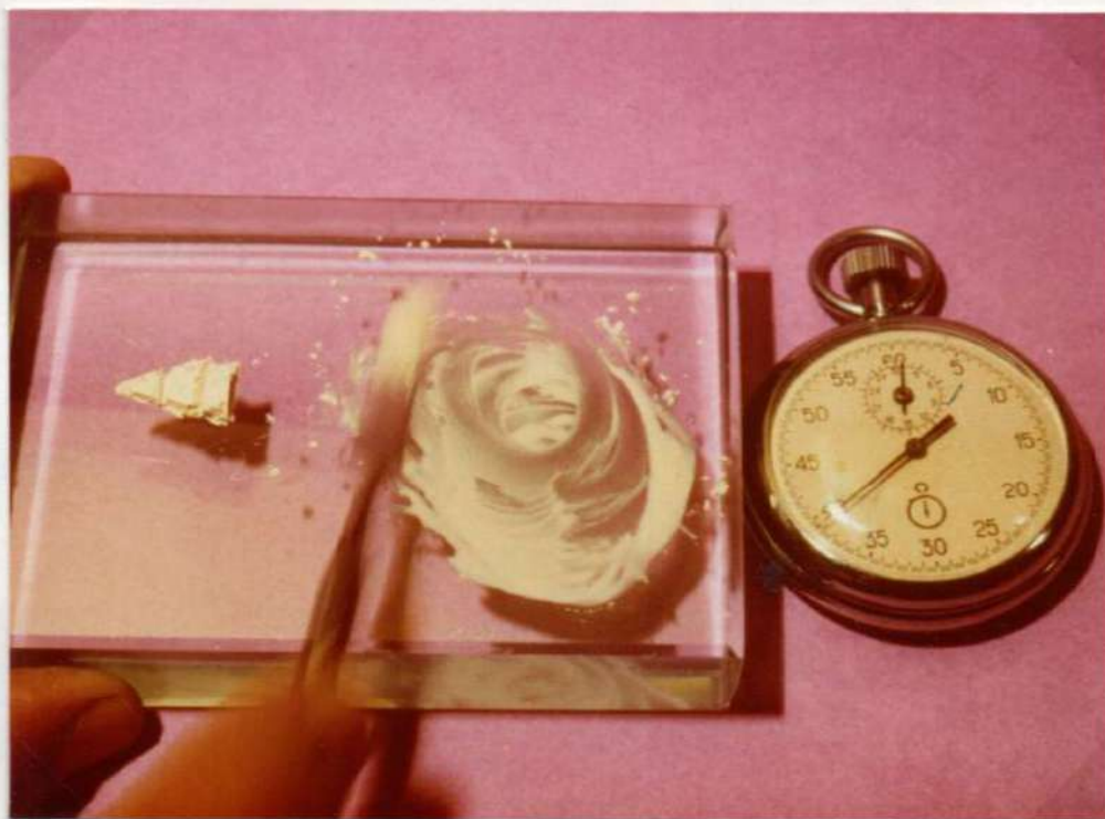
Figura 17. Técnica de preparación de un cemento de fosfato de cinc. Nótese el espatulado circular.
