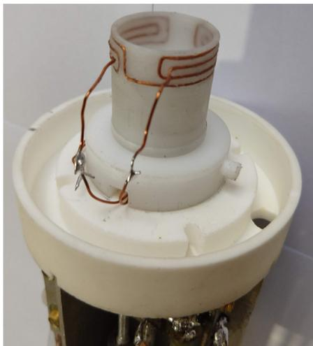
FIGURA 5.41: Bobina *saddle* doble instalada en el cabezal.
