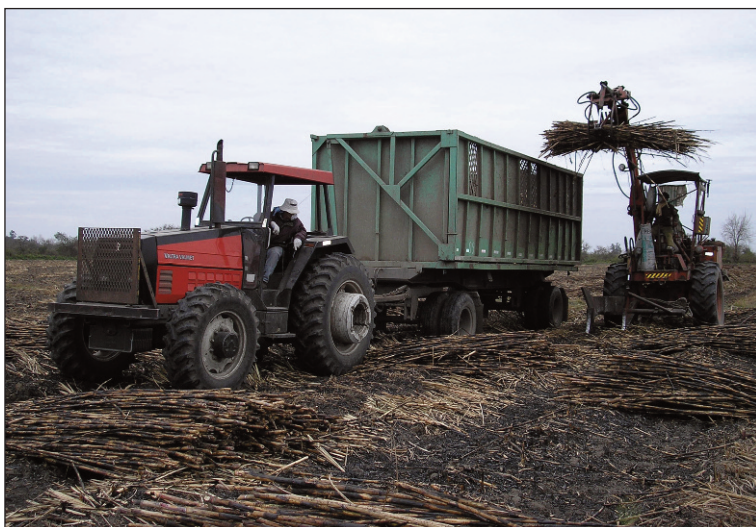
Figura 23. Máquina cargadora depositando caña en un carro tipo Java Fuente: Archivo de la AER Monteros (2012).
