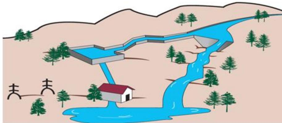
Figura 5. Aprovechamiento hidroeléctrico de tipo fluyente. (Instituto para la Diversificación y Ahorro de la Energía, 2006)
