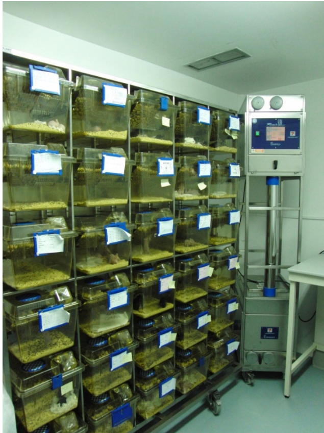
Figura 1 Rack ventilado. SCSIE Universidad de Valencia
