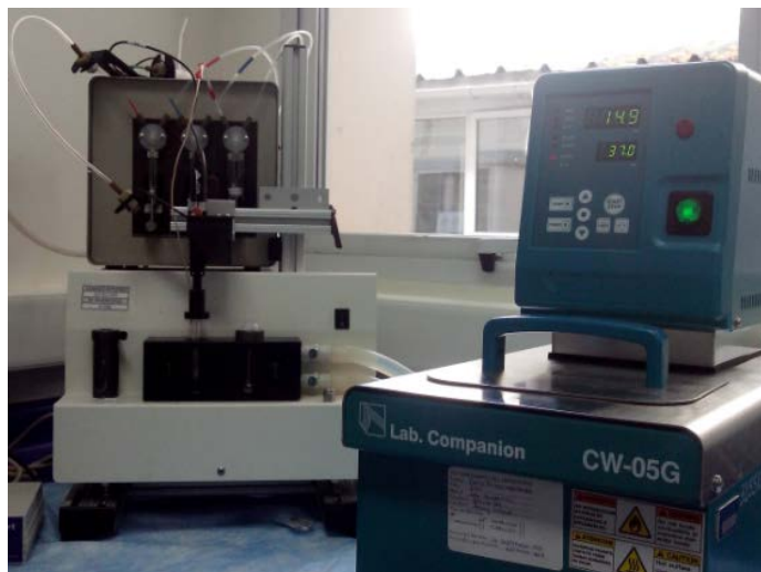
Figura 8. Fotografía frontal del equipo de titulación semiautomática Gemini Profiler. (baño termoregulado a la derecha).
