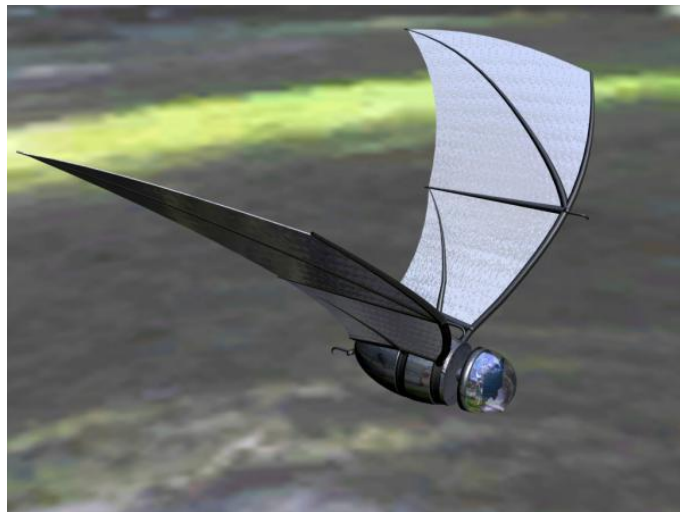
Figura 2.1: Microvehículo aéreo capaz de ejercer tanto el vuelo estacionario como el inestacionario, [22].
