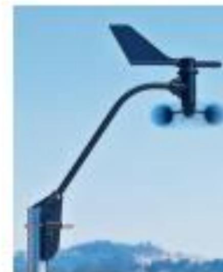
Figura 45: Sensor de intensidad y dirección del viento
