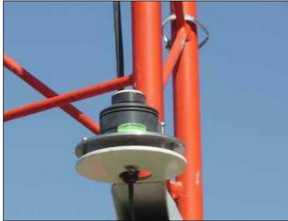
Figura 44: Sensor de radiación solar
