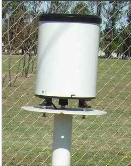
Figura 46: Sensor de precipitación
