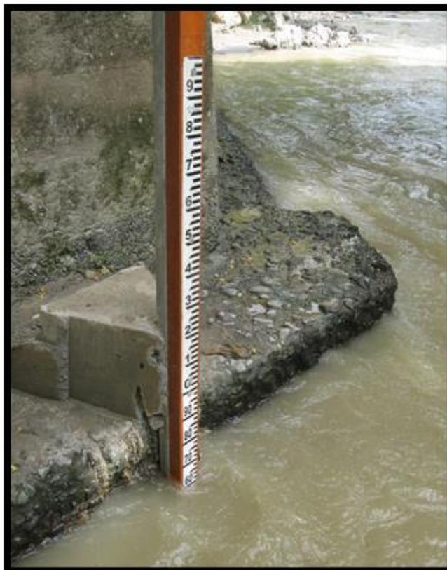
Figura 12: Escala hidrométrica
