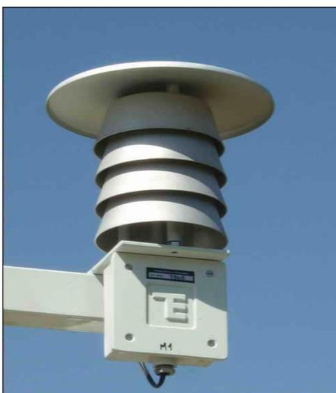
Figura 43: Sensor de temperatura y humedad del aire
