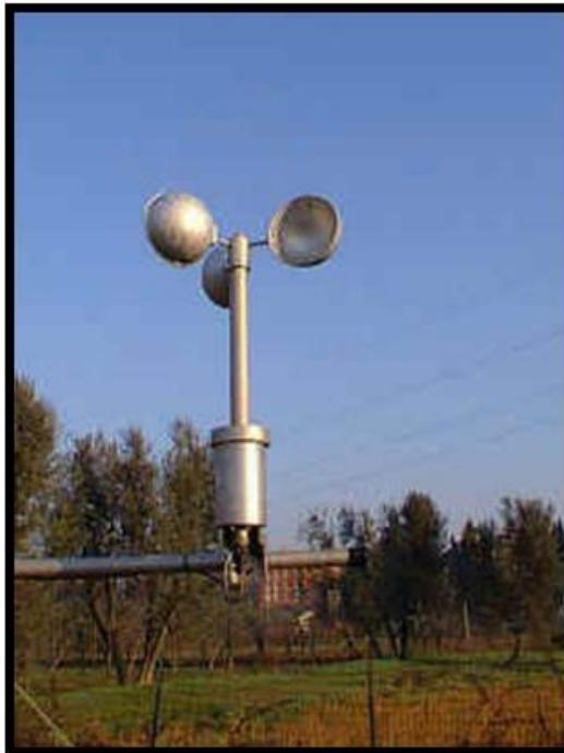
Figura 9: Anemómetro de cazoleta y hélice
