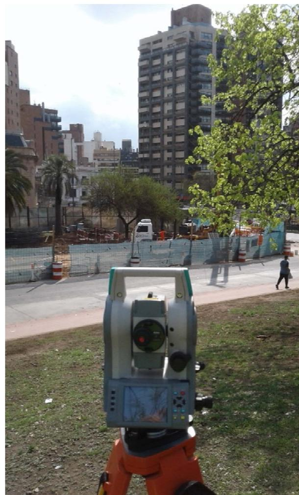
Figura 10: replanteo de pilote con estacion total
