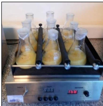
Figura 3.3. Frascos Erlenmeyer conteniendo maíz molido y solvente de extracción acetonitrilo: agua (84:16, V/V) en agitador orbital.
