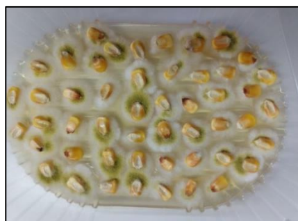
Figura 3.7. Granos de maíz sembrados en medio DG18 para la determinación de su carga fúngica a los 7 días de incubación a 25° C.
