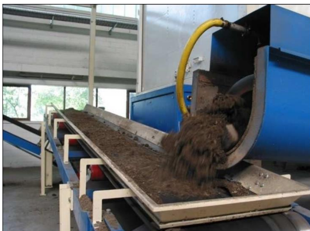
[La foto muestra la máquina mezcladora de los distintos insumos para la fabricación del biohumín. Escuela Agrícola Salesiana de Bogotá, mayo 2016.]
