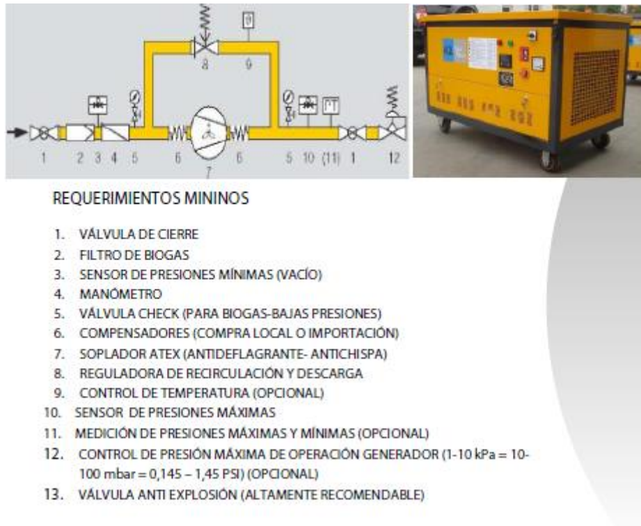
Figura 13 (a) y (b): Tren de calibración y los componentes del mismo Aqualimpia Engineering (2011-2012).
