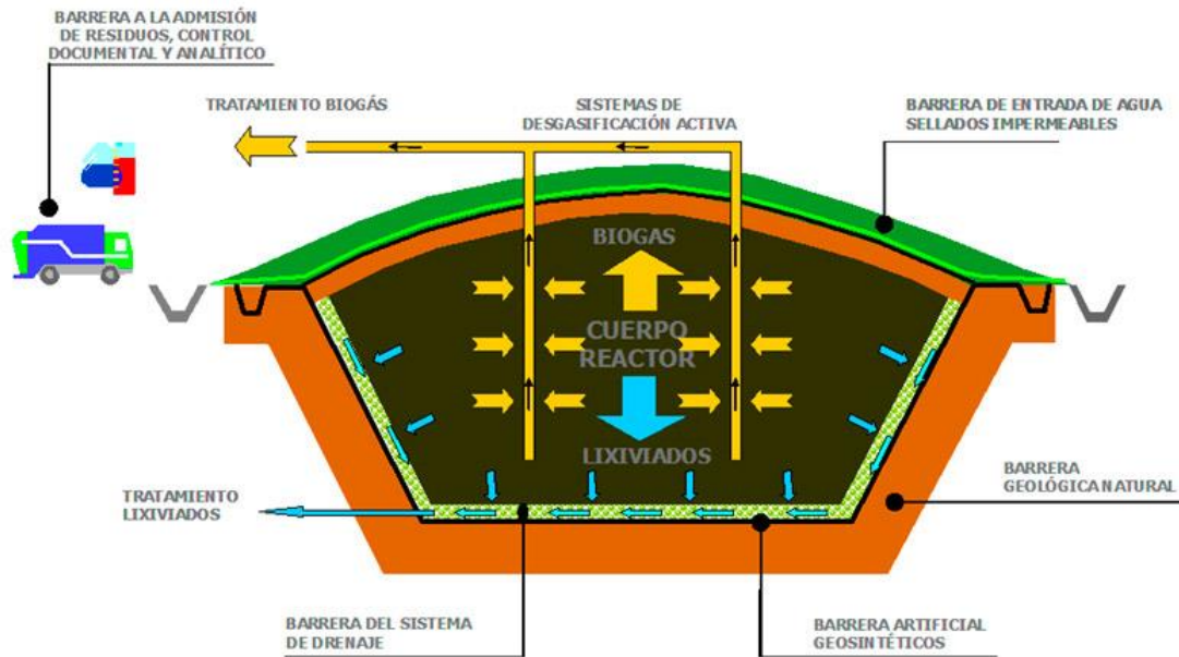
Figura 2: esquema común de un vertedero. FerranRelea(2011)
