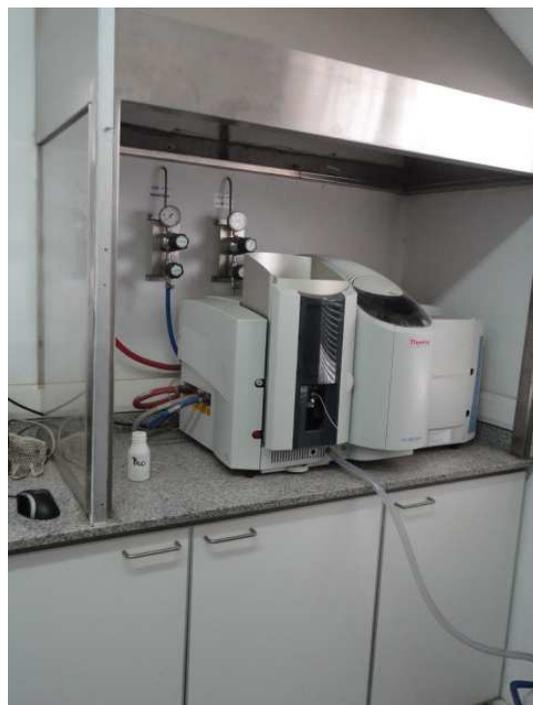
**Figura 17. Espectrómetro de absorción atómico, Biofarma, Córdoba.**
