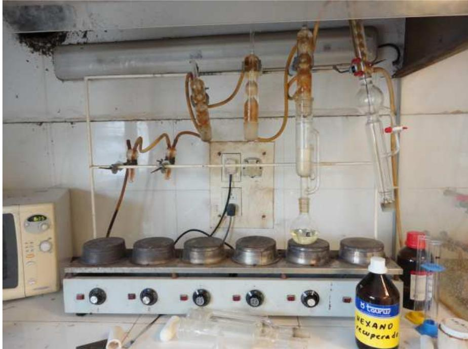
**Figura 20. Equipo para la determinación de proteína y contenido de nitrógeno proteico para alimentos balanceados, suelos y forrajes Biofarma, Córdoba.**
