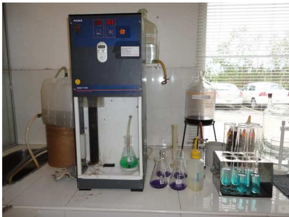
**Figura 19. Sistema de destilación para análisis de proteína Biofarma, Córdoba.**
