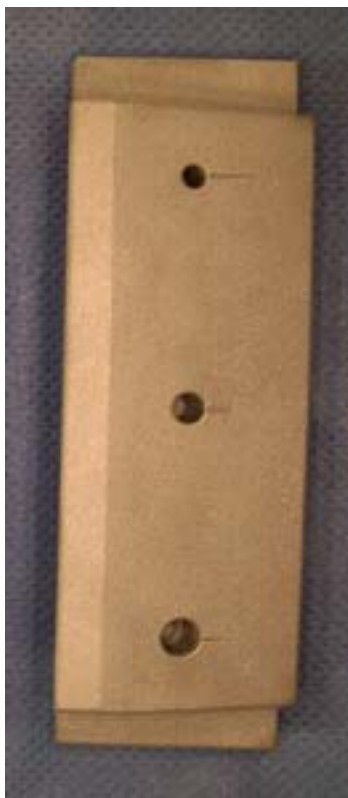
Figura 22: Base Angulada. En ambas figuras se observan: el escalón del extremo, las tres perforaciones y la inclinación en 15°, de la cara superior.
