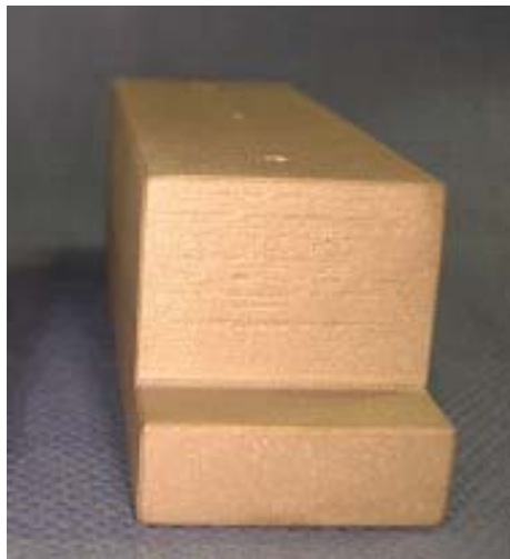
Figura 21: Base recta. A la izquierda vista superior con las tres perforaciones descritas. A la derecha, la misma base vista desde un extremo. Se observa en ambos extremos el escalón para fijarla.
