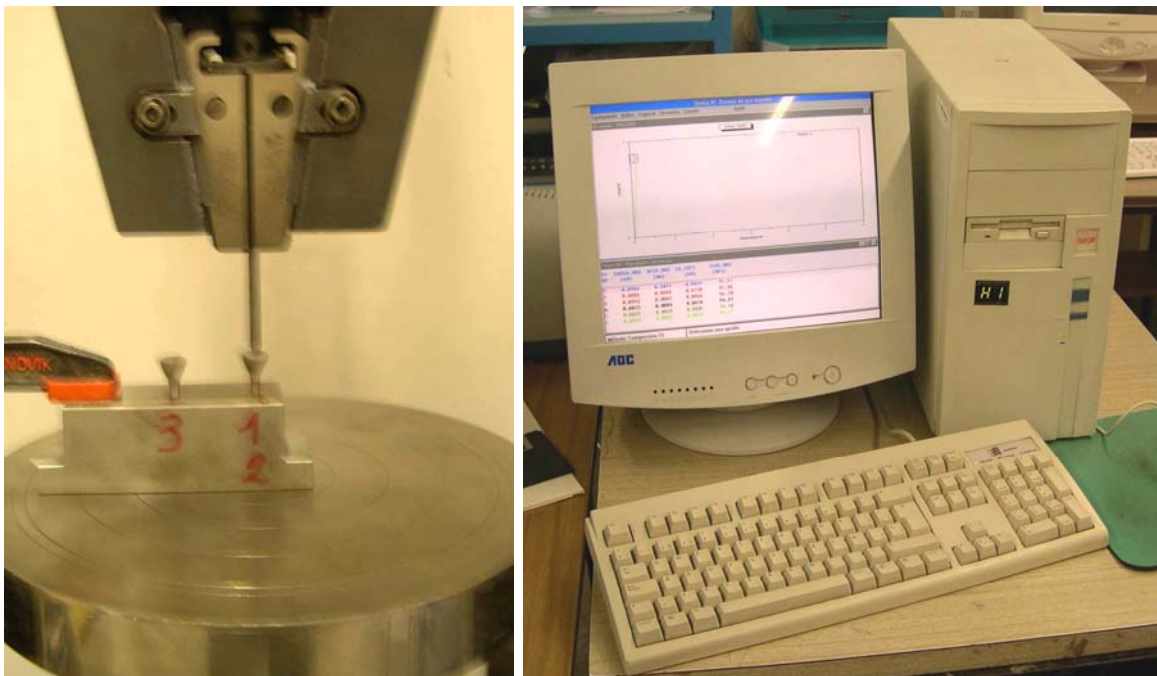
Figura 20: A la izquierda Mandril y vástago en momentos de realizar un ensayo. A la derecha puesto de computación en momentos de hacer un gráfico.
