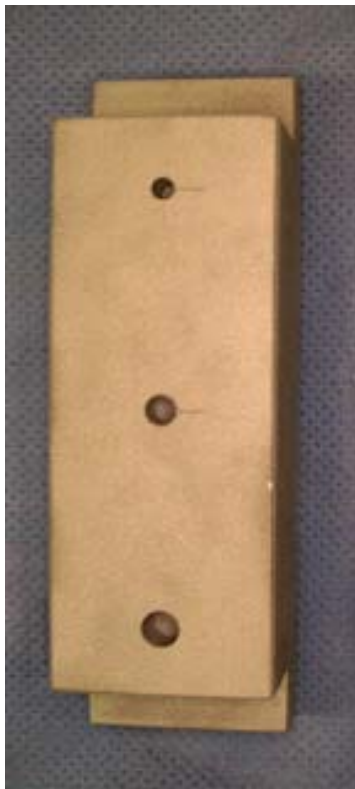
Figura 21: Base recta. A la izquierda vista superior con las tres perforaciones descritas. A la derecha, la misma base vista desde un extremo. Se observa en ambos extremos el escalón para fijarla.
