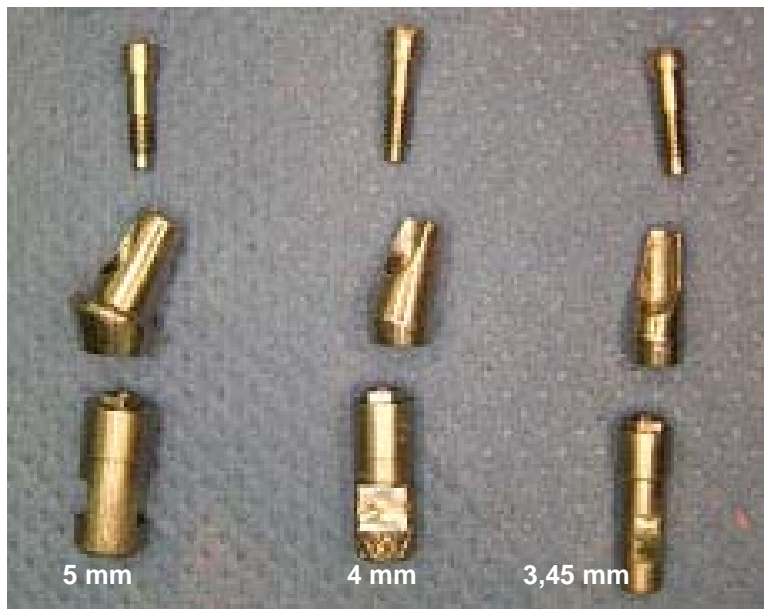
Figura 28: Conjunto análogo-emergente-tornillo angulados en 15°, de 3,45 mm, 4 mm y 5 mm
