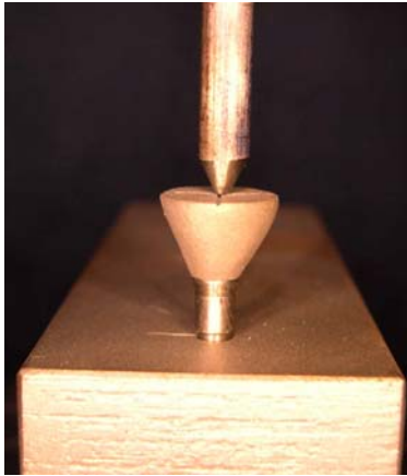
Figura 36: GRUPO 1. Emergente recto de 3,45 mm, carga centrada.
