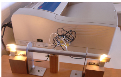
Fig. 3. Impresora digital con la lámpara extraída
